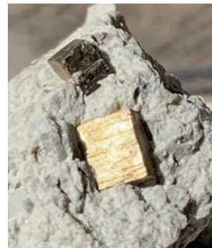
Foto. 02 : cristalli cubici di pirite nella massa argillosa (foto e coll. A Canal)
