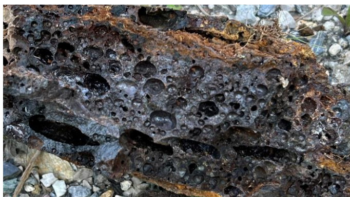
Foto 30: particolare di una scoria di tipo metallico caratterizzata dai tipici alveoli tondeggianti. (foto A. Canal)
