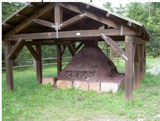
Foto 5: ricostruzione di una rosta di torrefazione (foto A. Canal)
