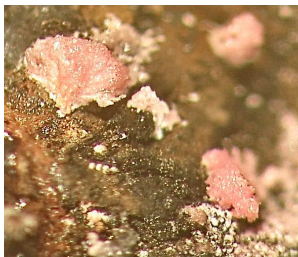
Foto 43: aggregati globulari di sferocobaltite all'interno dell'alveolo di una scoria di fusione (coll. e foto. A. Canal)
