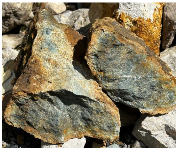
Foto 14: frammento di materiale proveniente dai filoni di esalazione sedimentaria con mineralizzazioni a solfuri di ferro (foto A. Canal)
