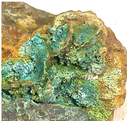
Foto 35: concrezioni di crisocolla in un campione di scorie in associazione con rame metallico (foto e coll E. Forcellini)
