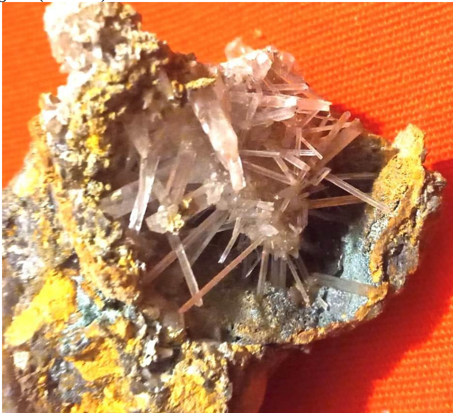
Foto 39: cristalli prismatici di gesso disposti irregolarmente all'interno di una cavità delle scorie di cappello delle roste di torrefazione (coll. e foto E. Forcellini)
