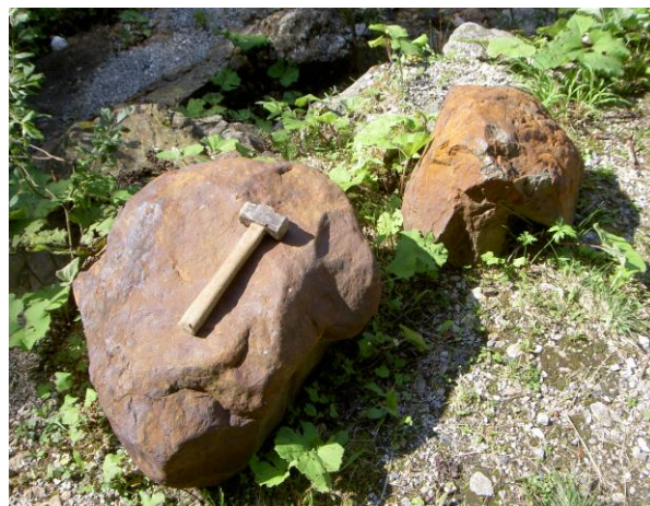
Foto 13: blocchi massivi di pirite, esternamente limonitizzata, presenti all'esterno della galleria Magni (foto A. Canal)
