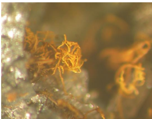
Foto 40: aggregato arborescente di goethite all'interno dell'alveolo di una scoria metallica (coll e foto A. Canal)
