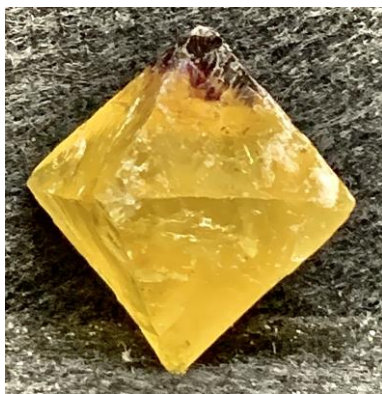
Foto. n°7: ottaedro di fluorite ottenuto per sfaldatura .USA. (col. D. Busetto foto A. Canal).
