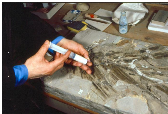
Foto 11: iniezione della resina cementante delle fessure del reperto
