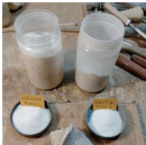
Matrice in polvere, grossolana e fine, pronta da utilizzare durante le fasi di incollaggio dei frammenti
