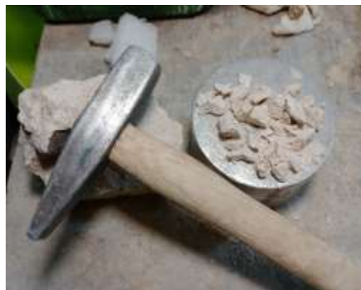
Preparazione di polvere della matrice da utilizzarsi durante l'incollaggio
